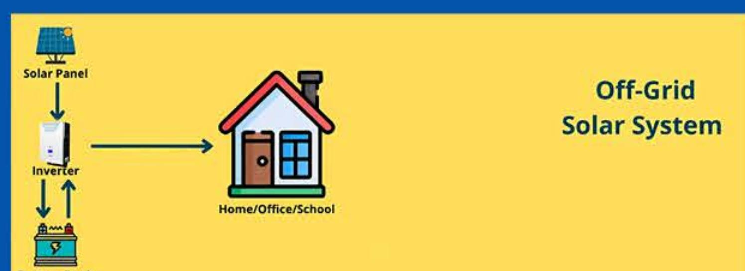
**1 إنفيرتر الطاقة المستقلة (Off-Grid Inverter):** يستخدم في البيئات التي لا تتوفر فيها شبكة كهرباء، ويعتمد بشكل أساسي على الطاقة الشمسية لشحن البطاريات، ثم يسحب الطاقة من البطاريات لتشغيل الأجهزة.
